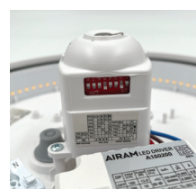
Justering av Pir-modellen med dip-switch.
