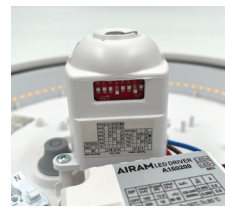
Pir-mallin säätö dip-kytkimellä.
